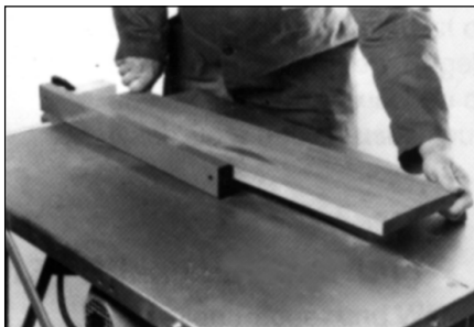
D Achtung! Den Austrittsbereich des Sägeblattes vor dem Sägen auf der Oberseite des Werkstückes anzeichnen und mindestens 150 mm Handabstand halten. Es besteht Verletzungsgefahr.
